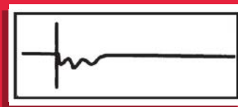
Vlhkost v kabelu
